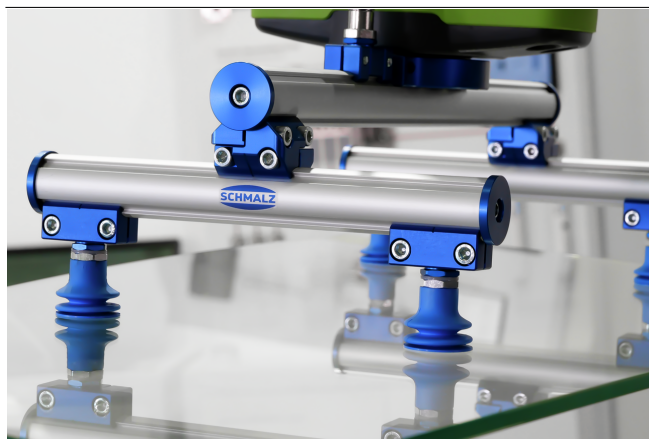
Sistema di presa modulare PXT che manipola una lastra di vetro
